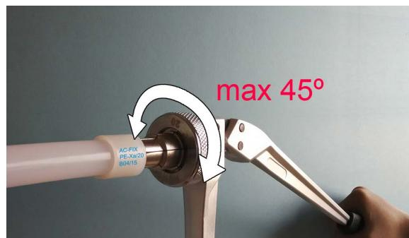
4. Pressionar lentament les palanques fins a ajuntar-les completament. En els casos on les dimensions dels tubs s'hi superin de 20 i superiors, mantenir juntes les palanques durant uns 3 segons.
