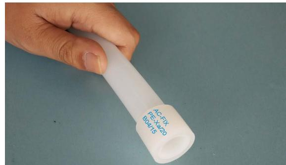
2. Muntar l'anell de plàstic al tub de manera que sobresurti una mica (màx. 1mm) del seu extrem. L'anell de plàstic ha d'estar ben ajustat al tub. Si queda solt, ficar-l'ho uns centímetres al tub i expandir una mica el seu extrem sense l'anell de plàstic. Després, tornar a posar l'anell de plàstic en la posició correcta a l'extrem del tub.
