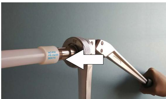
3. Obrir completament les palanques de l'eina i introduir el màxim possible els segments del capçal expandidor en el tub.
