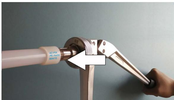
3. Abrir completamente las palancas de la herramienta e introducir los segmentos del cabezal expansor en el tubo todo lo posible.
